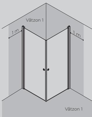
**SE** Skruvfästningar i våtzon 1 ska göras i betong eller annan massiv konstruktion (a), träreglar, träkortlingar (b) eller i konstruktion som är provad och godkänd för infästning, till exempel skivkonstruktion (c). Se exempel på godkända konstruktioner på säkervatten.se.
