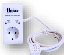
Lekkasje-stopper med strømkutt Lekkasje-stopperen registrerer signal fra sensortapen og forsyner magnetventilene med strøm. Den har eget strømuttak som automatisk kutter strømmen ved en eventuell lekkasje.
